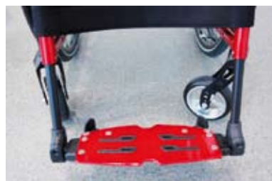
Höhenverstellbare Fußrasten und überarbeitete Lenkradaufhängung: Interessante Details der neuen Stühle
